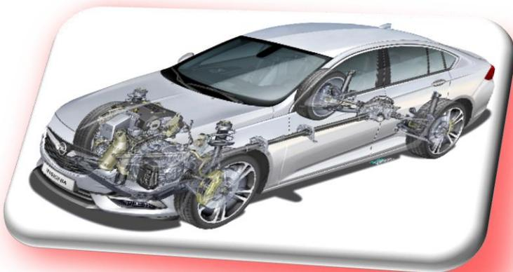
El chasis deportivo del *Insignia GSi* ofrece altísimos niveles de adherencia. Una contribución importante proviene de la tracción integral con reparto vectorial del par incorporado de serie, única en este segmento. Este sistema de alta tecnología, sustituye el diferencial convencional en el eje trasero por dos embragues que pueden acelerar cada rueda trasera individualmente en fracciones de segundo, dependiendo de la situación de conducción.
